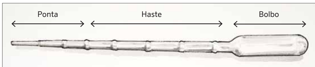
Estrutura elementar de uma pipeta descartável
