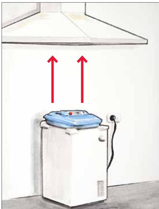
Exaustor de chaminé sobre um esterilizador a vapor sob pressão
